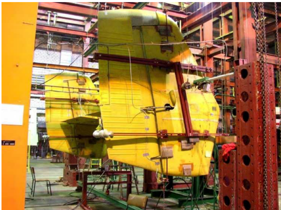
Rysunek 3.16: Stanowisko do badań zmęczeniowych usterzenia samolotu z połączeniem usterzenie kadłub [16]
