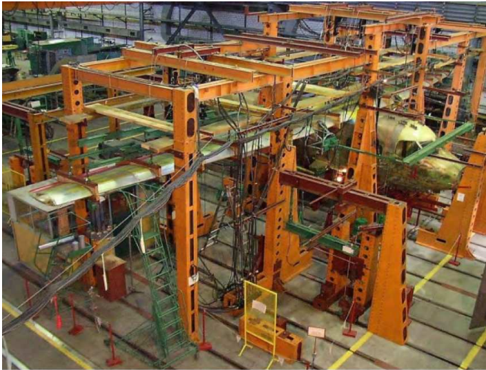
Rysunek 3.15: Stoisko do badań zmęczeniowych skrzydła i połączenia skrzydło-kadłub samolotu PZL M28 05. [16]
