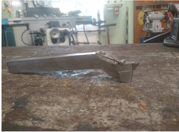
Rysunek 5.6: Nóż do strugania specjalistycznej konstrukcji
